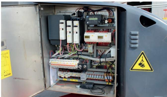
Entièrement contrôlé par la fréquence (démarrage progressif)
