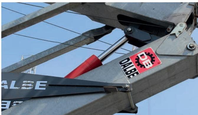
Piston hydraulique à l'intérieur du mât
